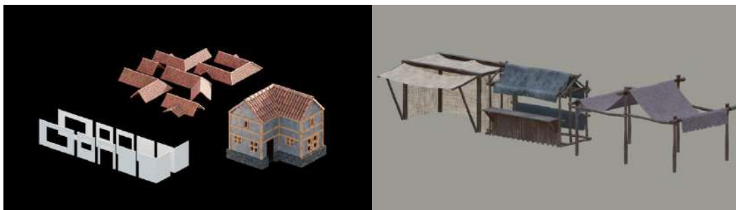
Gambar 7. Sistem Arsitektur Modular Bangunan dan Tiga Varian Stall
